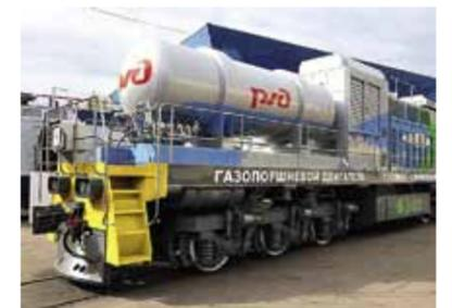
**Изготовлен и проходит испытания маневровый газопоршневой тепловоз ТЭМ19, работающий на сжиженном природном газе.**
