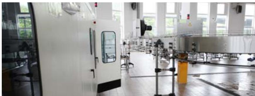
Филиал «Компания ПИТ», Калининград Линия розлива в ПЭТ бутылку, выдувная машина и воздушные транспортеры для перемещения готовых бутылок к автомату розлива.
