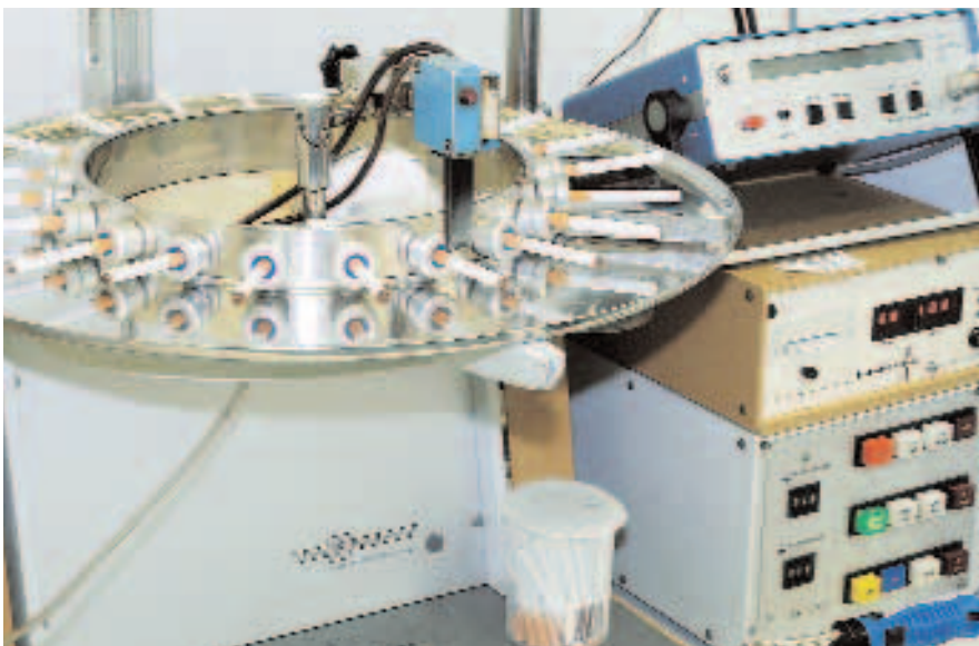
Курительная машина позволяет вести контроль показателей компонентов дыма (фабрика «БАТ-Ява»)
