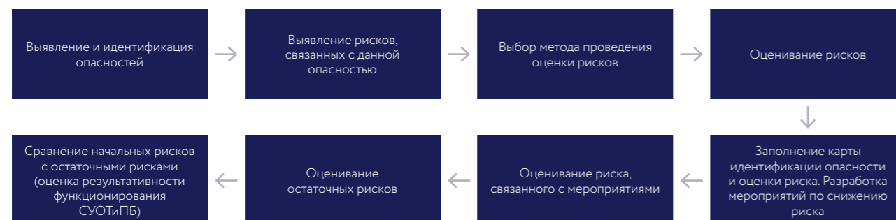
Рисунок 8. Алгоритм действий при оценке рисков, связанных с производственной опасностью
