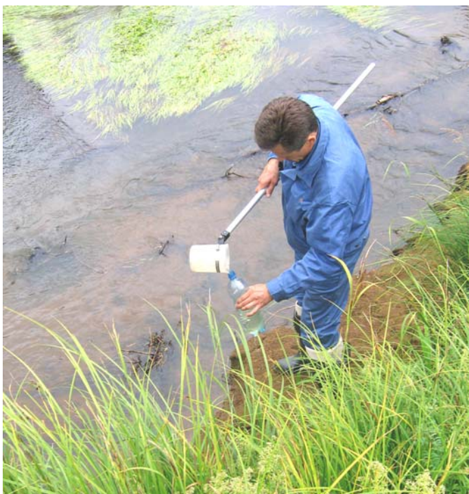
Отбор проб воды на участке магистрального газопровода
