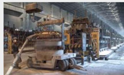
В 2005 году все 25 корпусов электролиза Братского алюминиевого завода были переведены на более экологичную технологию «сухого» анода. Этому событию предшествовала работа по внедрению на предприятии технологии «полусухого» анода и модернизация оборудования цеха анодной массы, в том числе полномасштабная реконструкция поточных линий цеха. На БрА-Зе введено в эксплуатацию новое оборудование для термоподготовки коксовой шихты и пека.
