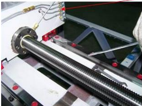
Подвод смазки ко всем механическим узлам
