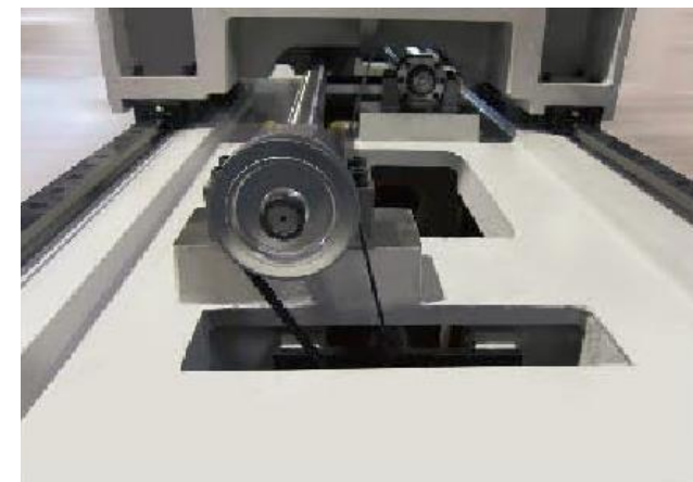
Прецизионные линейные направляющие и ШВП обеспечивают точность перемещений
