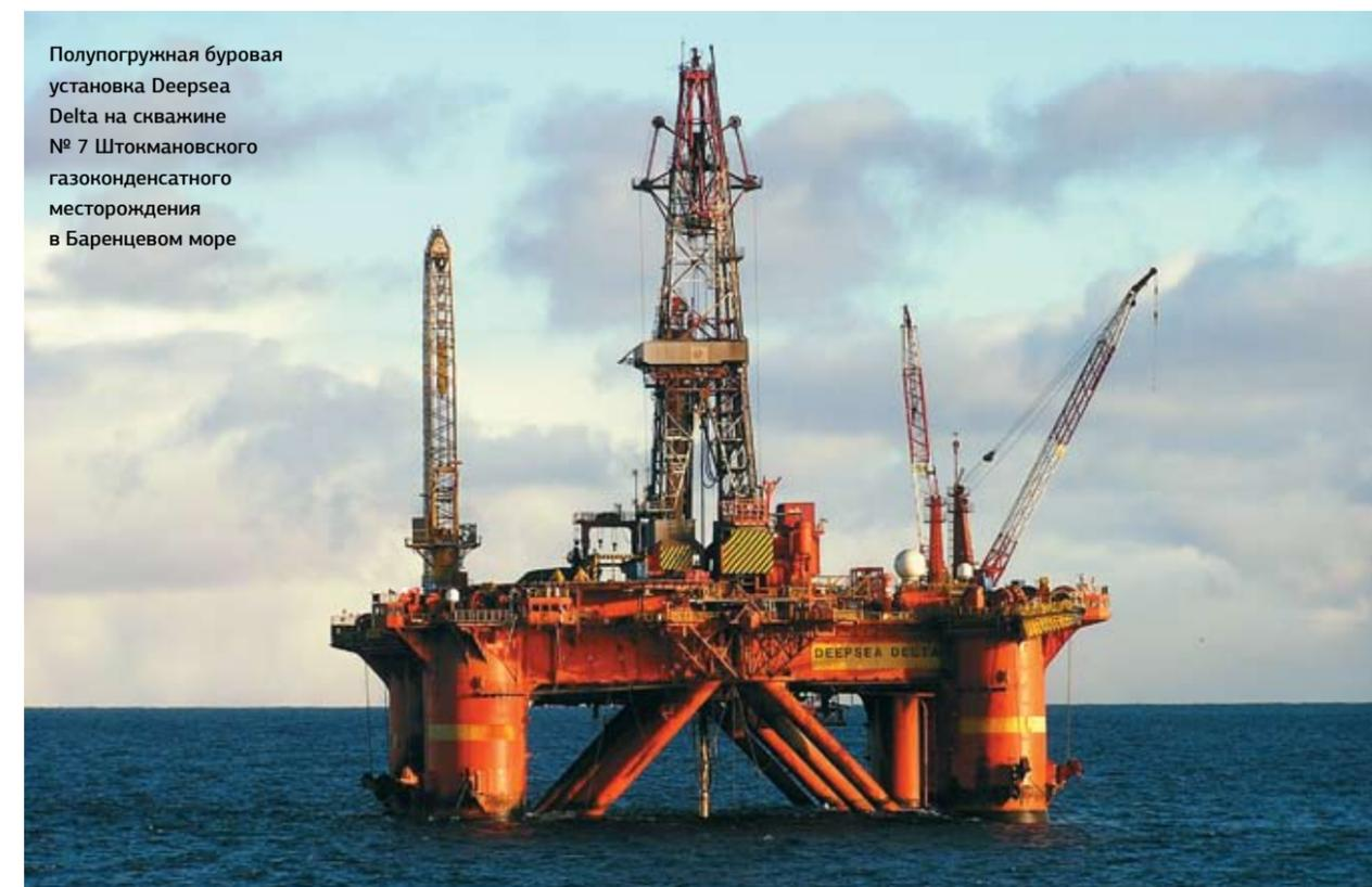
Полупогружная буровая установка Deepsea Delta на скважине № 7 Штокмановского газоконденсатного месторождения в Баренцевом море
