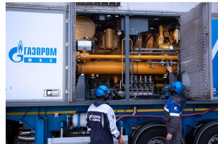
Предотвращение выбросов парниковых газов (метана) с использованием мобильных компрессорных станций при подготовке участков магистральных трубопроводов к проведению ремонтных работ
