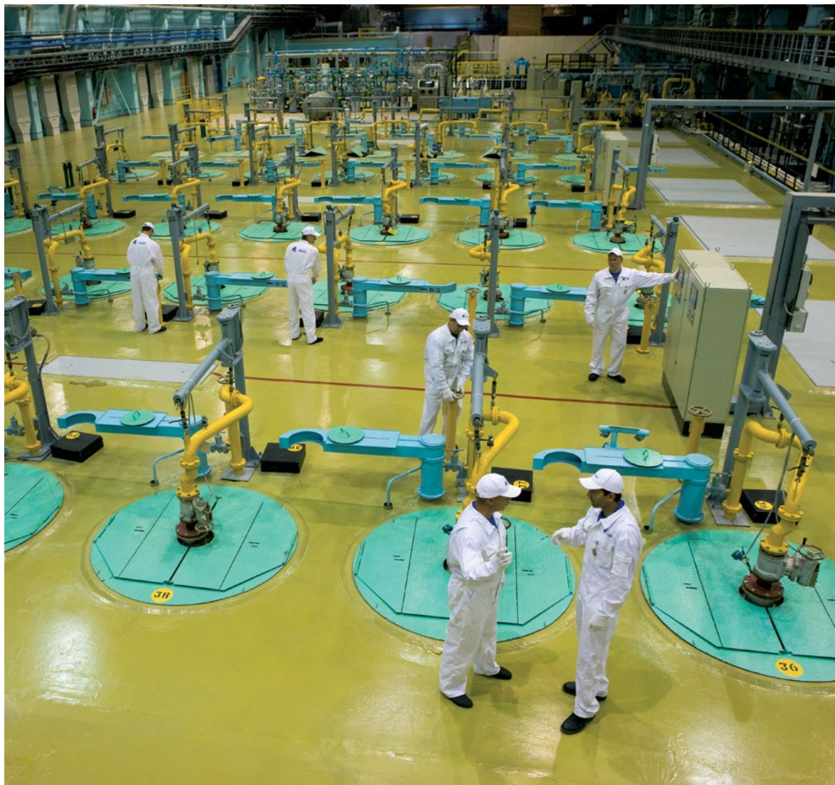
ОАО «ЭХЗ». Цех вторичной переработки гексафторида урана
