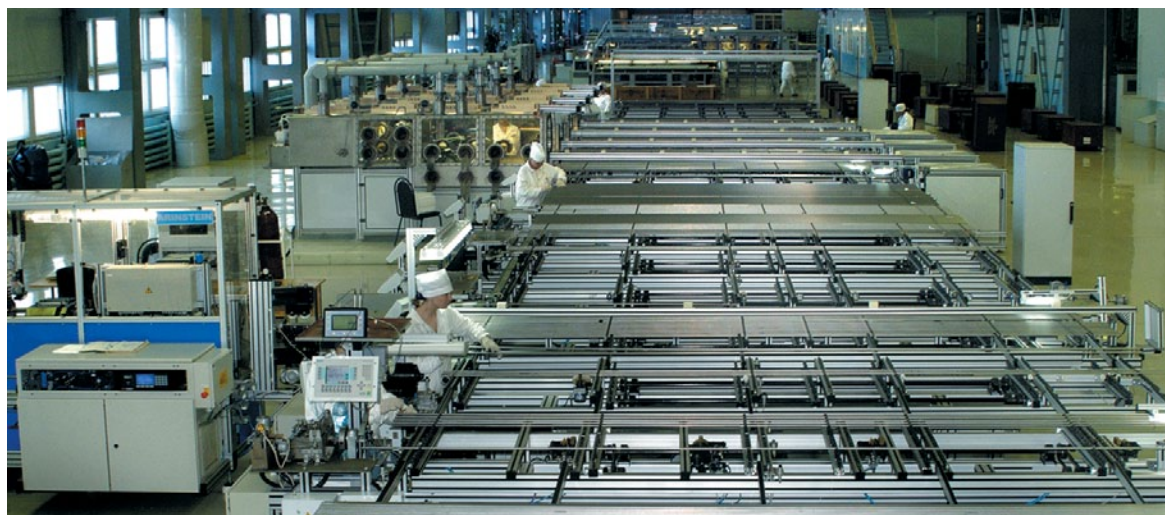
ОАО «МСЗ». Линия по производству ТВЭЛ для ВВЭР
