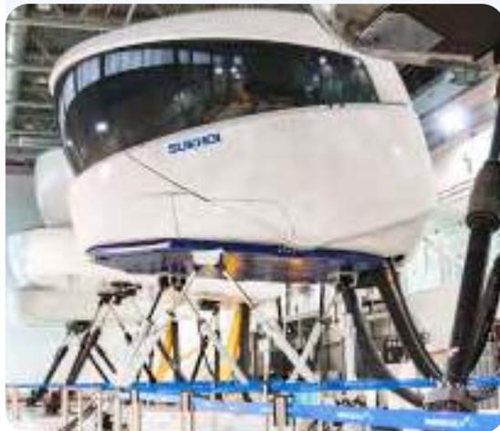
Тренажерный комплекс для пилотов, оснащенный симуляторами всех типов воздушных судов, находящихся в эксплуатации у Компании.
