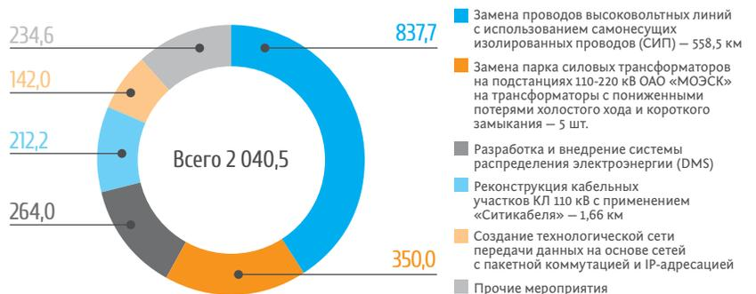
и затраты на строительство, а также исключает возникновение риска аварии с возможными экологическими последствиями — выбросом десятков тонн кабельного масла. Использование сетей с пакетной коммутацией и IP-адресацией способствует повышению надежности системы сбора и передачи технологической информации.
