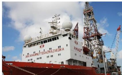
Буровое судно, способное бурить скважины глубиной до 6 500 м при максимальной глубине моря 1 740 м
