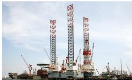
Самоподъемная буровая установка, способная бурить скважины глубиной до 6 000 м при максимальной глубине моря 100 м
