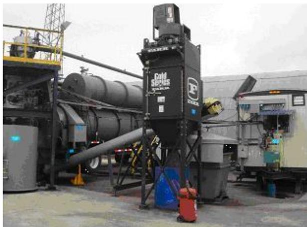
Строительство термодесорбера завершает создание безотходного комплекса по переработке нефтесодержащих отходов.
