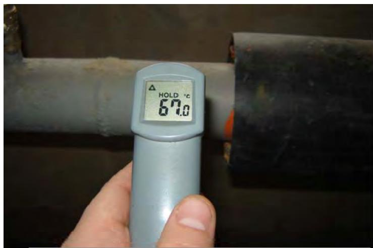
обеспечивающих обогрев собственно производства, а также зданий административного и хозяйственно-бытового комплекса. Капитальный ремонт данных тепловых сетей осуществлялся около 15 лет назад. Для ремонта теплотрасс применены стальные трубопроводы с пенополиуретановой изоляцией в полиэтиленовой оболочке, достоинствами которых являются долговечность (до 50 лет) и сверхнизкие тепловые потери.
